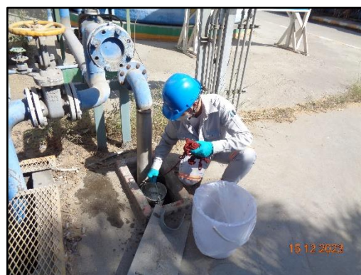
ภาพที่ 3.24 การตรวจวัดคุณภาพน้ำ บริเวณ Regenerate resin ที่ระบายลงสู่บ่อเก็บน้ำทิ้งรวม
