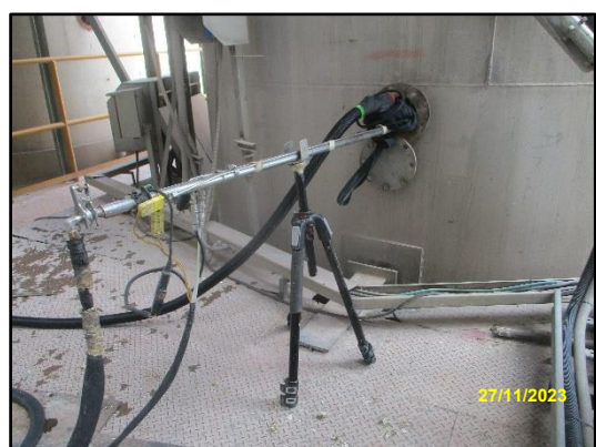
ภาพที่ 3.7 การตรวจวัด TOC จากปล่องหม้อเผา
