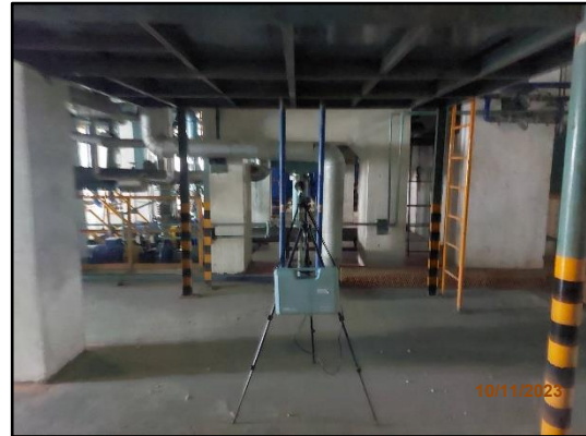
ภาพที่ 3.34 การตรวจวัดระดับเสียงบริเวณเครื่องจักร บริเวณปั๊มท่อส่งไอน้ำ
