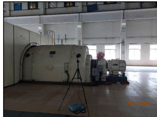
ภาพที่ 3.36 การตรวจวัดระดับเสียงบริเวณเครื่องจักร บริเวณเครื่องกำเนิดกระแสไฟฟ้า
